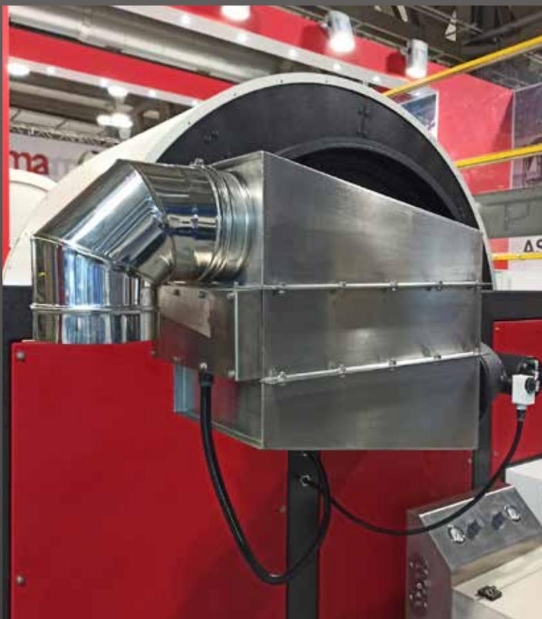
**SISTEMA DI RISCALDAMENTO A RESISTENZE ELETTRICHE**
